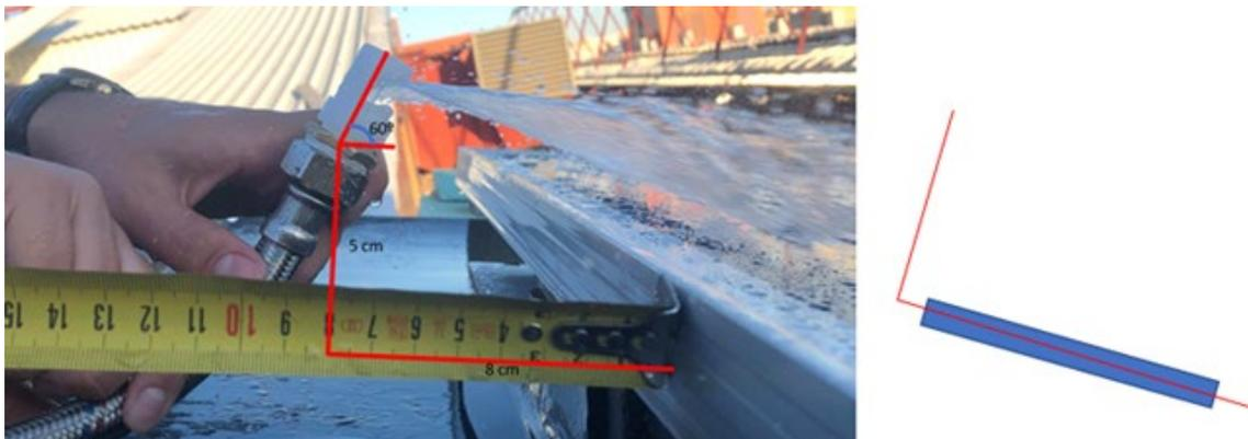
**Figura 5.** Disposición óptima de la boquilla
